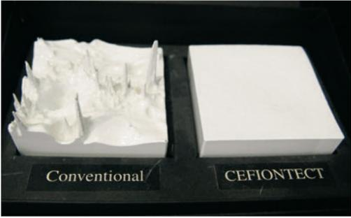
TOTOのセフィオンテクトは、ナノレベル(髪の毛の太さの10万分の1のサイズ)でトイレ表面を超平滑にできる技術。これにより汚物が付きにくく、付着しても簡単に取り除くことができる。写真(左:従来の陶器表面、写真右:セフィオンテクトの表面)
